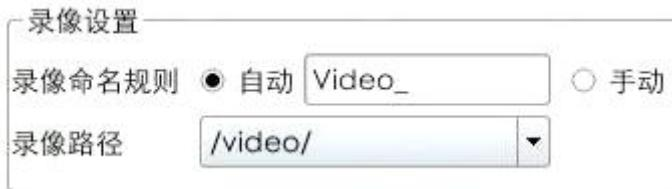
①相机录制的文件自动命名规则为“Video\_N”，当前相机总录制的视频数量减 1 为“N”，自动保存在 U 盘 camera 文件夹内“video”文件夹下。外部存储建议使用 USB3.0 U 盘，仅支持 FAT32 格式，待主界面下方图标出现“
