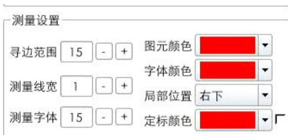
寻边范围：与 2.4.5 测量工具“自动寻边”关联，开启自动寻边后测量状态下，测量点移动到物体边缘的范围值。
