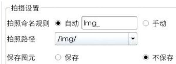
① 相机拍照自动命名规则为 Img\_N，当前相机总拍摄的图片数量减 1 为 “N”，保存在 U 盘 camera 文件夹内 “img” 文件夹下。外部存
